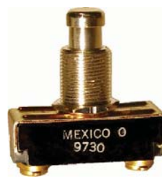
170 ON - MOM. OFF 172 OFF - MOM. ON 10 amp. 250 volt 15 amp. 125 volt
